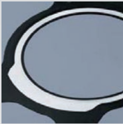
ガスケットの表面剥離
