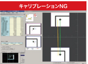
オートキャリブレーション結果: 実際の位置関係と異なり上下配置
