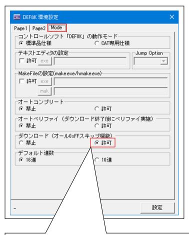
パケットサイズのバイト全て OxFF の場合は、ターゲット側にデータ送信しない 処理を許可するスイッチです。 ダウンロードスピードを速くするための処置
